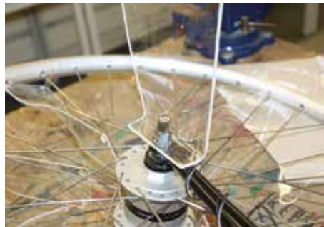
Felge mit Rotorblatt
